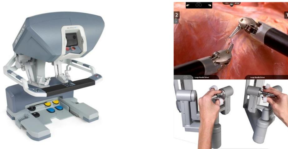
**Figure 2. Console pour chirurgien du système da Vinci® Si HD et les manettes de la console**
