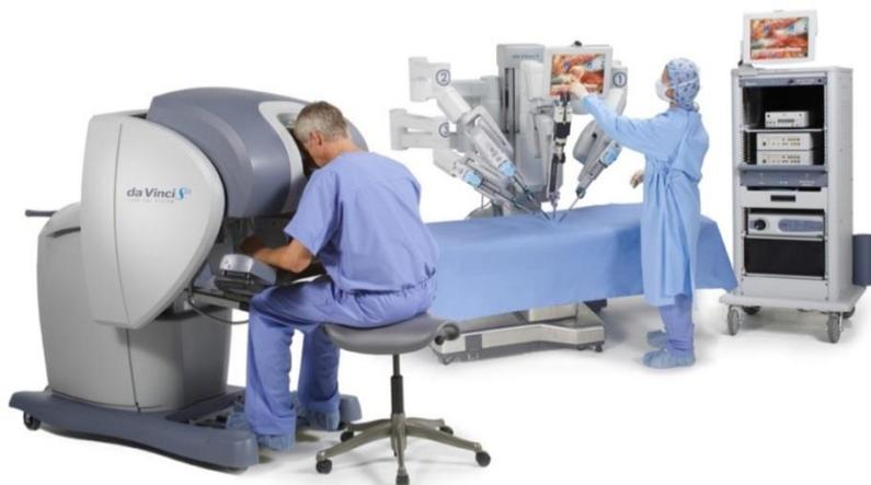
**Figure 1. Système chirurgical da Vinci<sup>®</sup> S**
